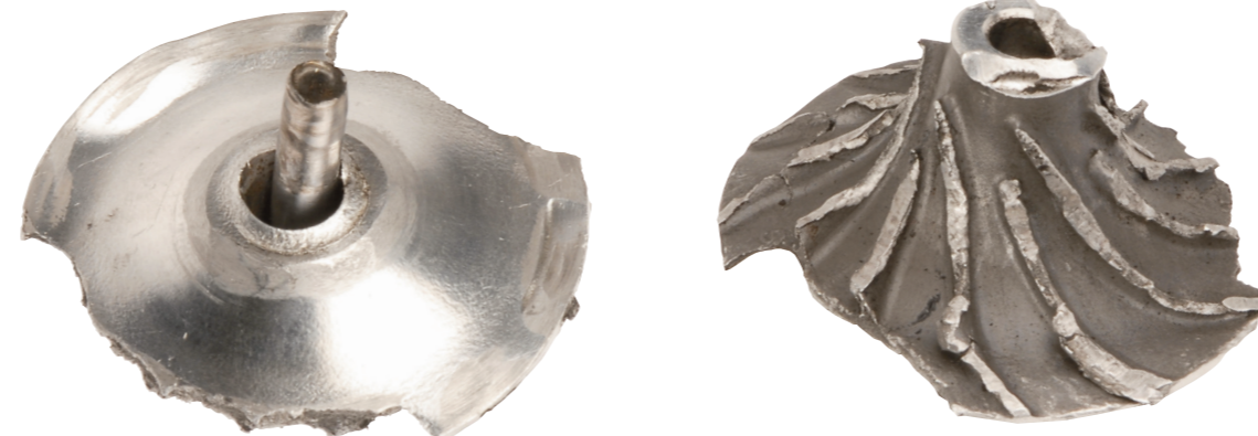
Rozerwanie koła kompresji
